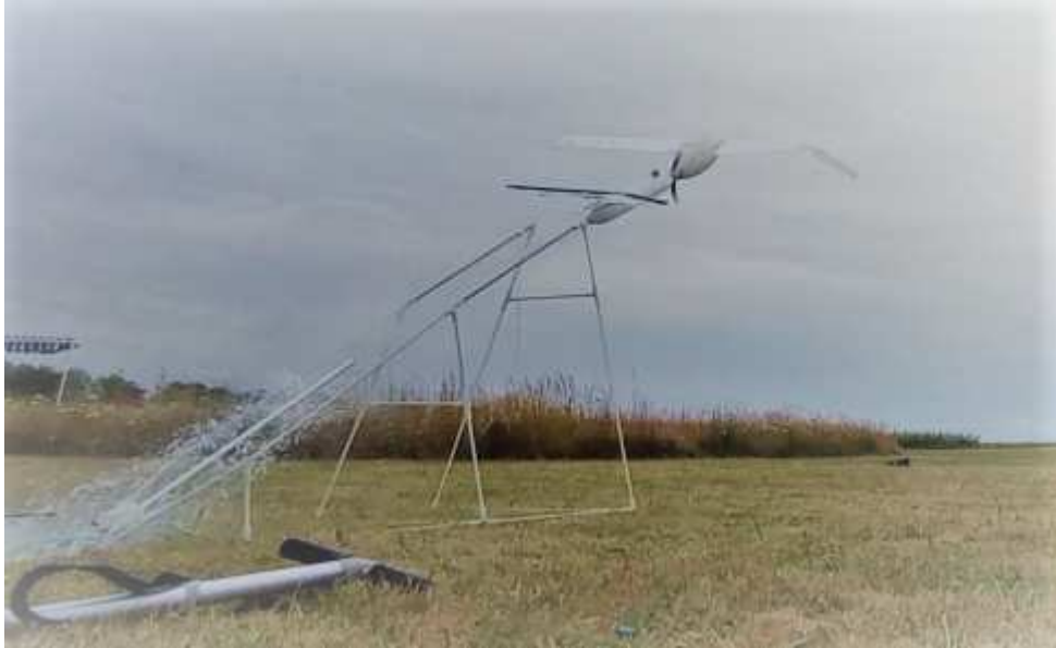
Décollage avec propulseur hydro pneumatique (fusée à eau)
