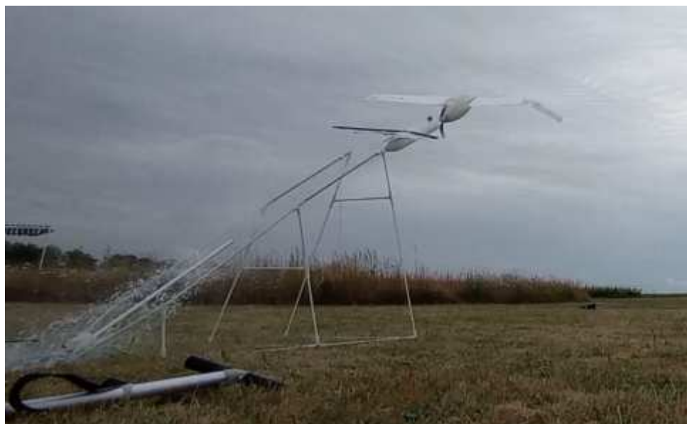
Décollage avec propulseur hydro pneumatique
