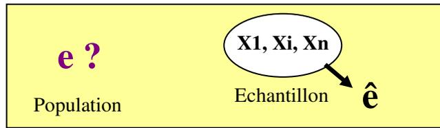
Estimation  $\hat{e}$  d'un paramètre  $e$  caractéristique de la population à partir d'un échantillon  $\{X_1, X_i, X_n\}$
