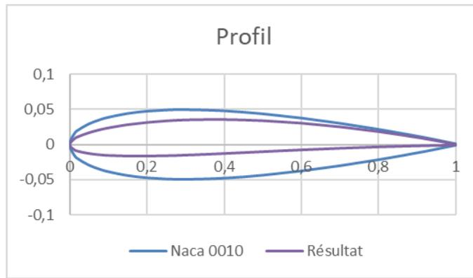
On constate que ce résultat n'aurait pas pu être obtenu avec une méthode d'optimisation locale car la fonction CD ( $k1, k2$ ) n'est pas convexe, comme le montre le graphe de la feuille de calcul et d'interface présentée ci-dessous.
