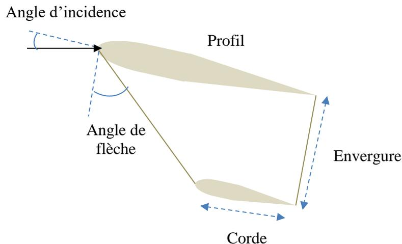
La traînée et la portance ont respectivement pour expression  $\frac{1}{2} \rho S V^2 C_D$  et  $\frac{1}{2} \rho S V^2 C_L$  où les coefficients aérodynamiques  $C_D$  et  $C_L$  ne dépendent que du profil.
