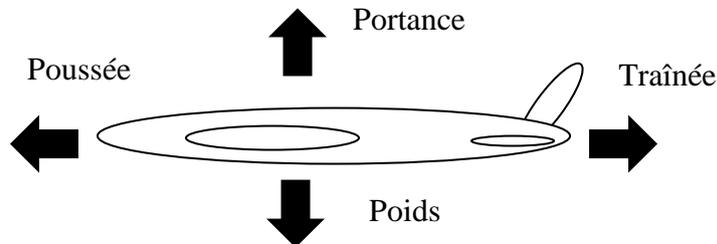
En régime de croisière, ces forces s'équilibrent. La traînée doit être la plus faible possible pour réduire la poussée et limiter ainsi la consommation en énergie.
